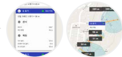
▲ 크레인 클릭 시 상세 정보 표시 및 근접 크레인과의 거리 실시간 모니터링 가능
