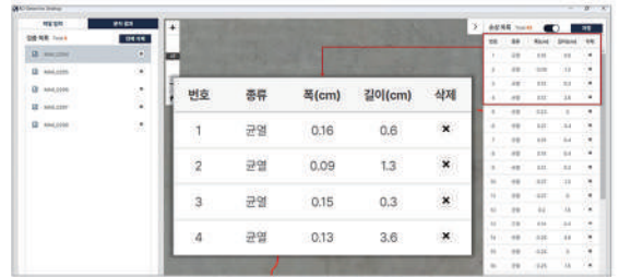
실제 크기로 환산 영상 속 검출된 손상을 실제 크기(px->cm)로 변환하여 정확한 분석이 가능합니다.
