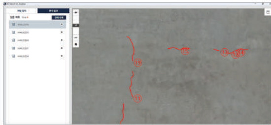
딥러닝 기반 시설물 손상 검출 시설물의 손상정보를 자동으로 신속하게 검출합니다.
