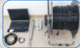
지하수 유량유속 측정
