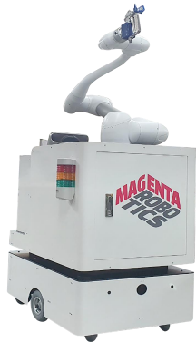
자율 페인팅 로봇-GT3 PAINTER 시제품
