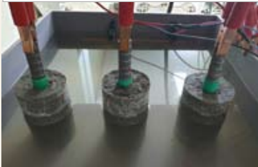
28일 경과 후에도 바이오크리트 몰탈과 콘크리트는 부식 발생이 전혀 없음
