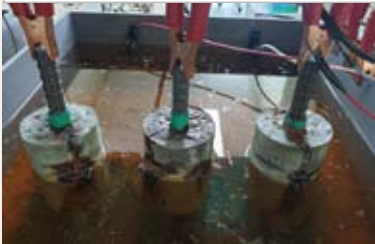
28일 경과 후에도 바이오크리트 몰탈과 콘크리트는 부식 발생이 전혀 없음
