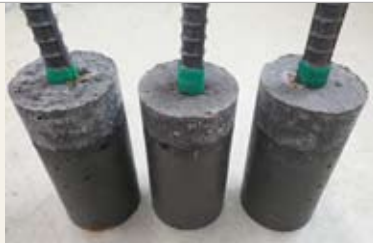
28일 경과 후에도 바이오크리트 몰탈과 콘크리트는 부식 발생이 전혀 없음
