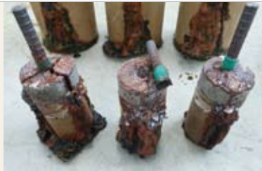
28일 경과 후에도 바이오크리트 몰탈과 콘크리트는 부식 발생이 전혀 없음
