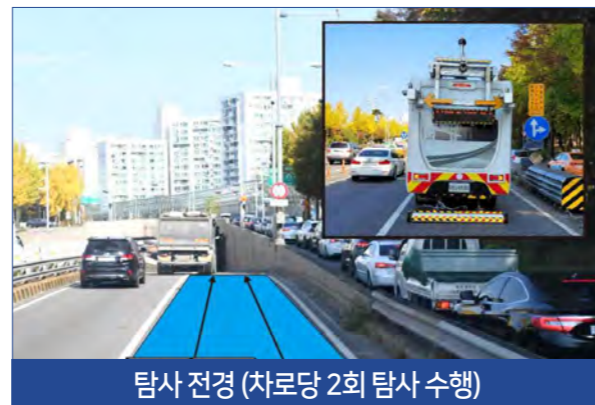
고주파수 GPR탐사 장비(2GHz), 1회 탐사 폭 1.6m
