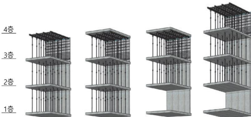
1. 3층 거푸집 설치 2. 3층 콘크리트 타설 3. 1층 동바리 해체 4. 4층 거푸집 설치 (4층으로 인양)
