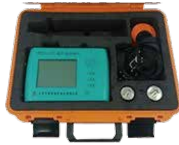
모델명 CHT225-A 용도 콘크리트 초음파 강도 측정
