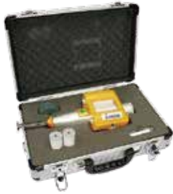
모델명 PROCEQ SCHMIDT NR-10 용도 콘크리트 타격 강도 측정
