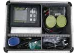
모델명 SONICON-32 용도 콘크리트 초음파 강도 측정
