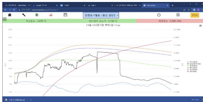
그림 2 콘크리트 수화열 모니터링 및 예측시스템 웹 GUI
