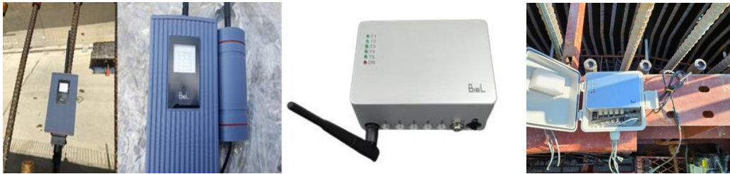
그림 1 콘크리트 수화열 측정을 위한 IoT 무선 계측기
