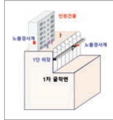
3. 1단 띠장 설치 / 노출경사계 설치
