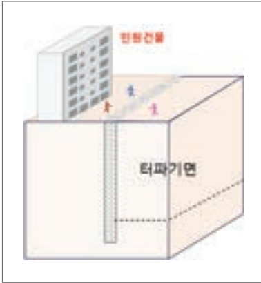
1. 차수, 휴막이벽 공사
