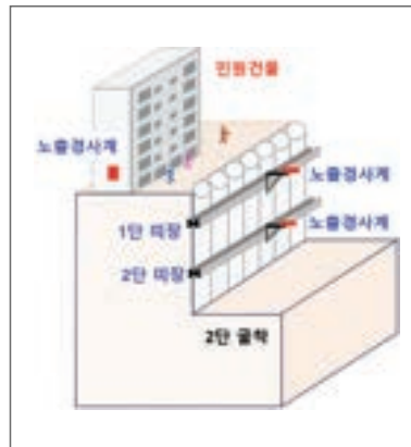
5. 2단 띠장 설치 / 노출경사계 설치
