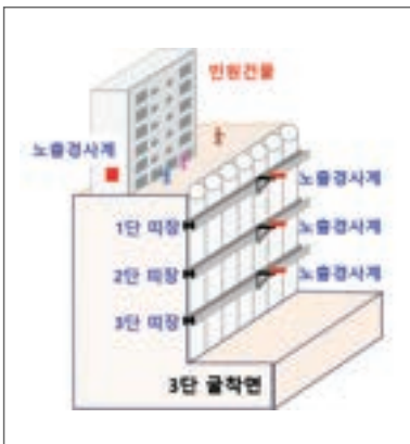
7. 3단 띠장 설치 / 노출경사계 설치
