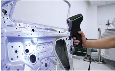
프레스 스프링백 측정 및 모델링 보정
