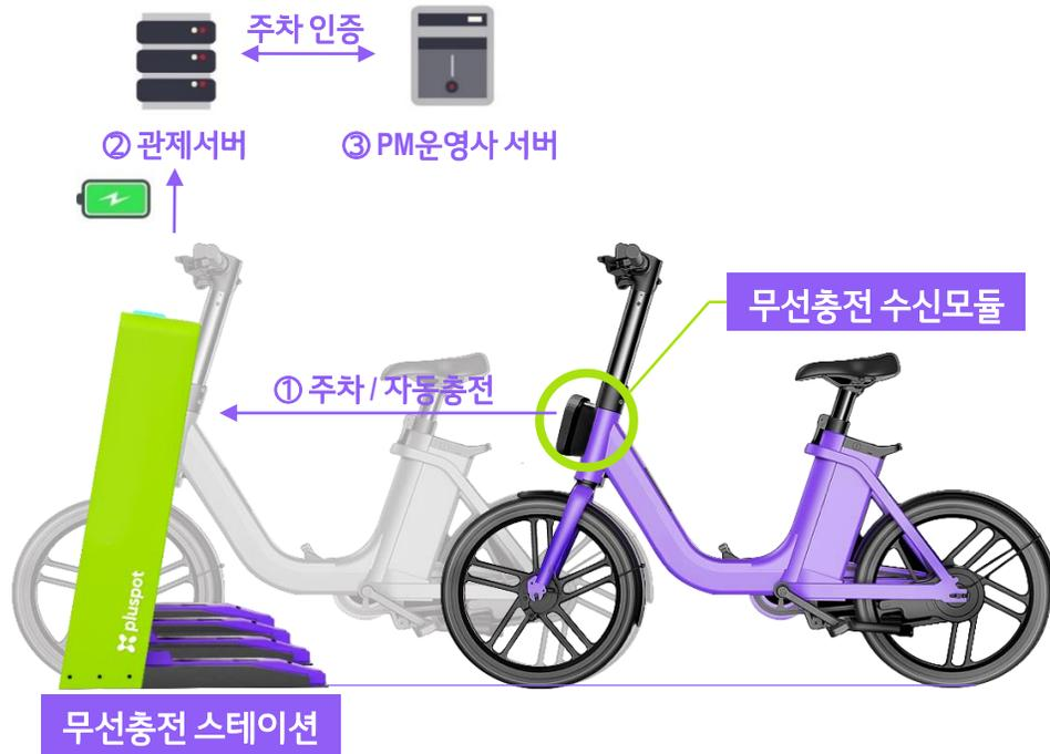
무선충전 스테이션으로 배터리 충전 운영 효율과 지속 가능한 모빌리티 서비스 운영이 가능합니다.
