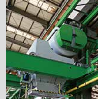
콘크리트 이송 버킷
