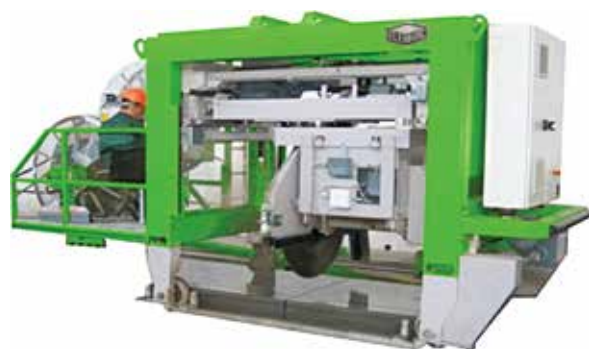
양생 후 성형된 HCS를 고객의 요구에 따라 일정 길이로 절단하는 설비 (반자동 운전식)
