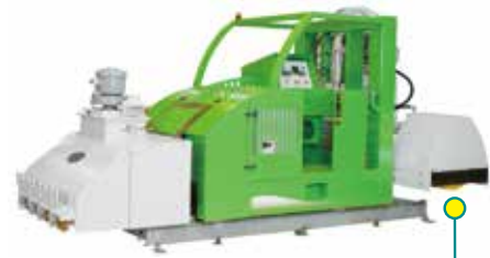
Preparer 생산 준비를 위한 성형 라인(Bed) 청소 및 강연선 포설 장비
