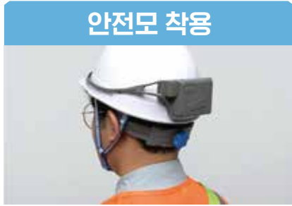
안전모 착용밴드를 이용해 AIoT 기기를 안전모에 착용할 수 있습니다.
